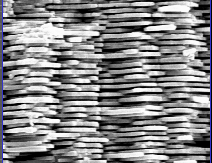
珍珠母材料断口微结构形貌
