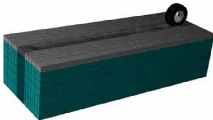
(a) 轮胎-土壤耦合的三维有限元模型
