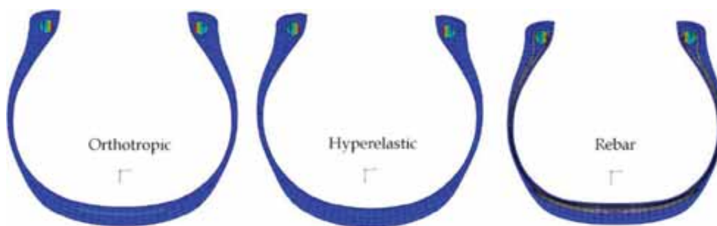
图 24 二维轴对称轮胎有限元模型 [78]
