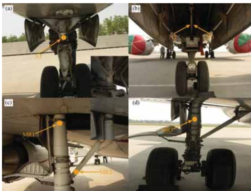
图 55 飞机起落架结构应变测量位置
