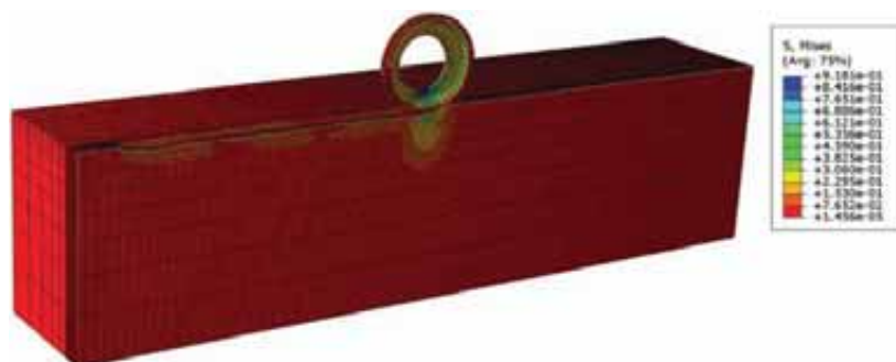
(c) 机轮压入土壤后的应力云图
