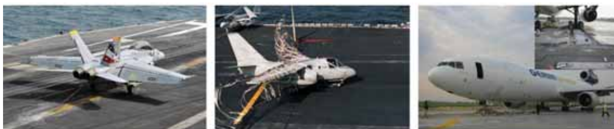
图 2 飞机阻拦系统: (a) 拦阻索; (b) 拦阻网; (c) 道面拦阻系统
