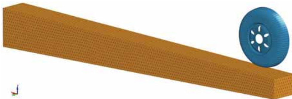
图 70 飞机机轮-梯度道面拦阻系统有限元模型
