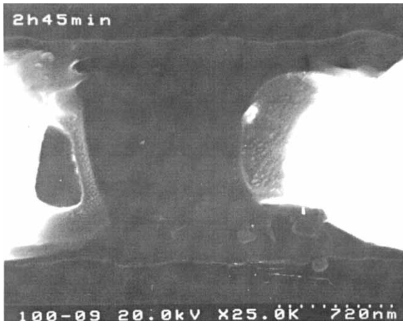
图 12.7 局部温升过高使薄膜铝导线熔断
